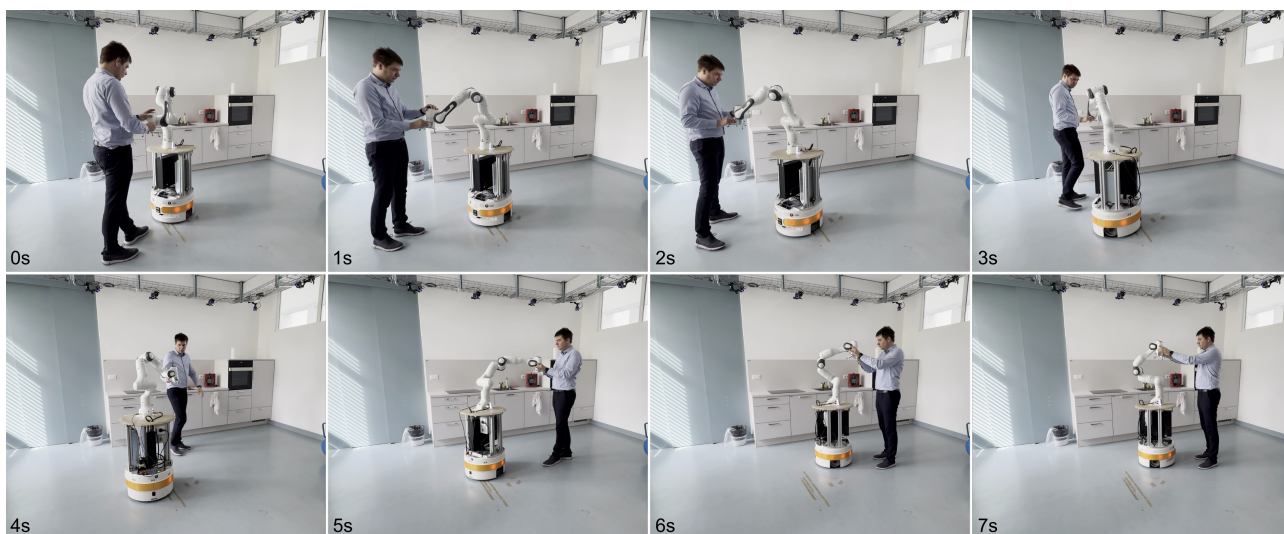
Slika 5: Zaporedje gibov med kinestetičnim vodenjem. Uporabnik fizično premika robotsko roko, medtem ko se mobilni robot samodejno prilagaja gibanju vrha robota, da ohrani dosegljivost.
