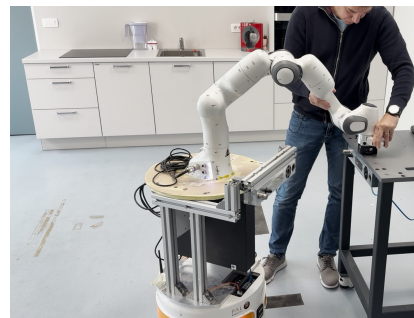
(c) Mehanska sklopitev robotske roke z referenčno točko na modularni mizi.
