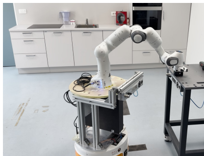
(a) Mobilna platforma po določitvi relativne lege glede na modularno mizo.
