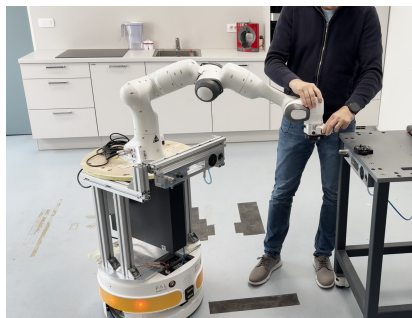
(b) Kinestetično vodenje celotne mobilne platforme preko vrha robotske roke.
