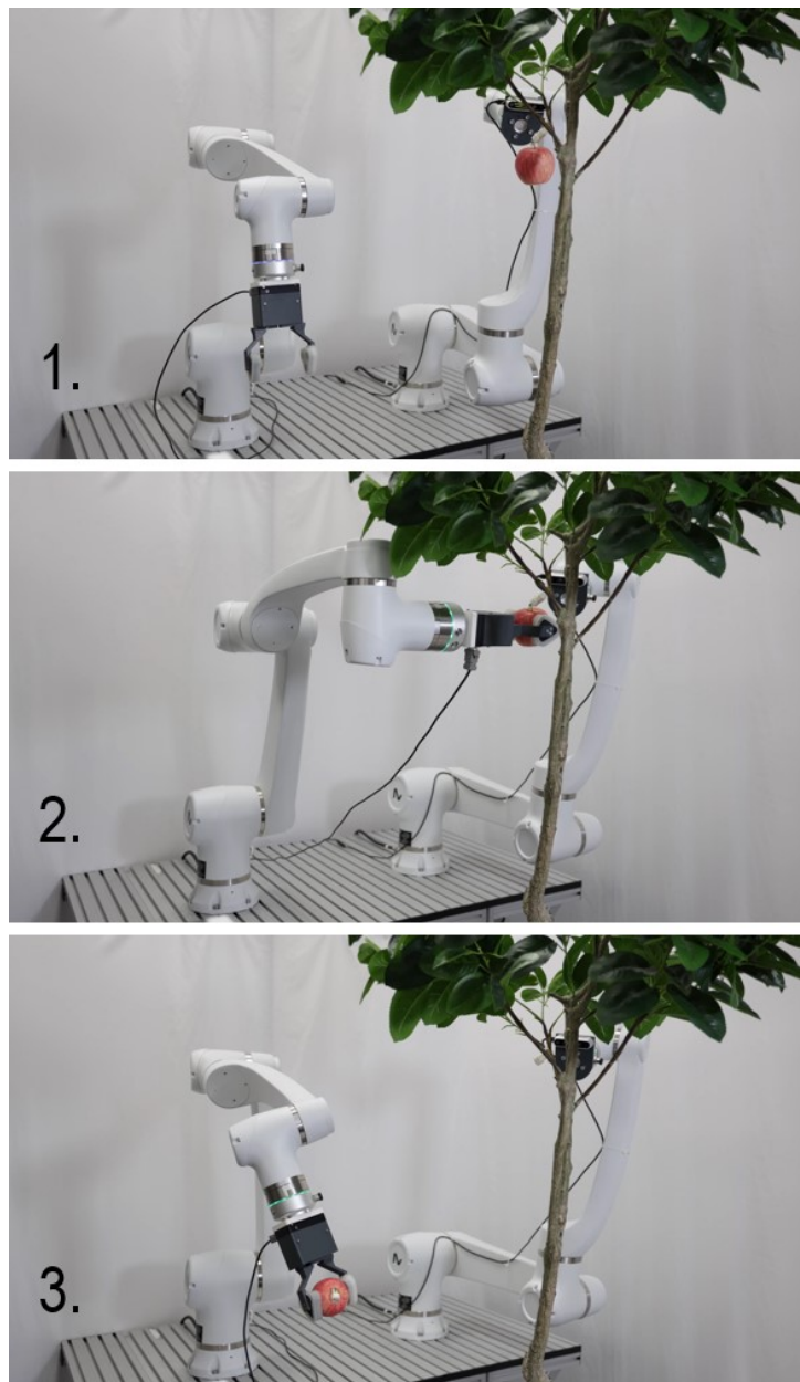
Slika 16: Postopek obiranja jabolk z uporabo robotskega vida.
