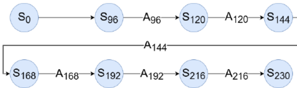
Slika 2: Shema prikazuje, kdaj operater vpliva na manipulativne spremenljivke opisane z A_t . Ob času t \in \{96, 120, 144, 168, 192, 216\} operater izvede akcijo A_t na podlagi trenutnega stanja opisanega s S_t .
