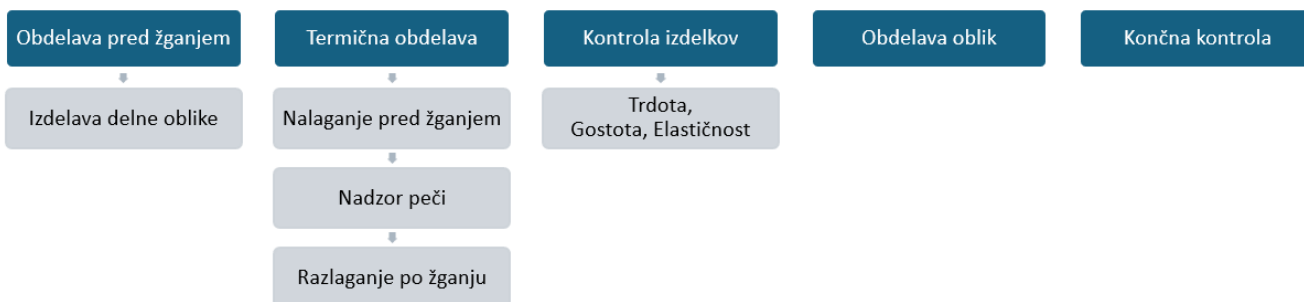
Slika 7: Druga faza izdelave brusov in prikaz povezanih proizvodnih operacij
